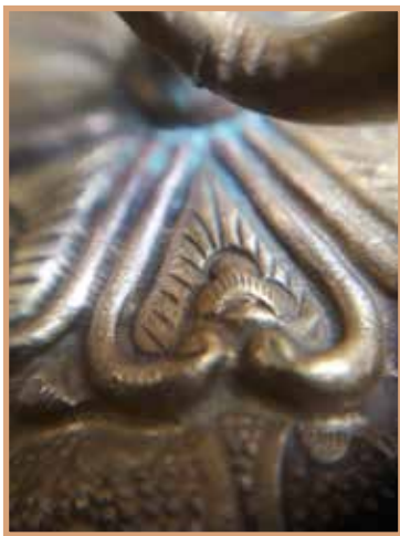
คราบสีเขียวบนเครื่อง เงิน ทองแดง และโลหะ ผสมของทองแดงหลัง ทำความสะอาดด้วย สบู่ที่มีรสเปรี้ยวหรือ น้ำยาทำความสะอาด ที่มีฤทธิ์เป็นกรด
