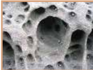
หินที่ผุเปื่อยจากฝนกรด แร่บางชนิดในเนื้อหินถูกละลายออกไป จนเนื้อหินโปร่งพรุน
