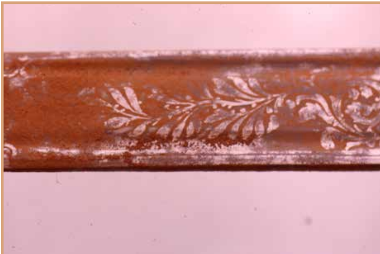
สนิมบนเหล็กที่มีองค์ประกอบ แตกต่างกัน
