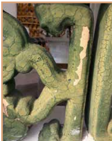
การเสื่อมสภาพของน้ำยาเคลือบบนเครื่องปั้นดินเผา
