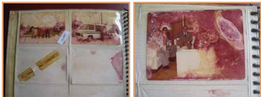
อัลบั้มที่ทำจากพลาสติกราคาถูกทำให้ภาพถ่ายเสื่อมสภาพ
