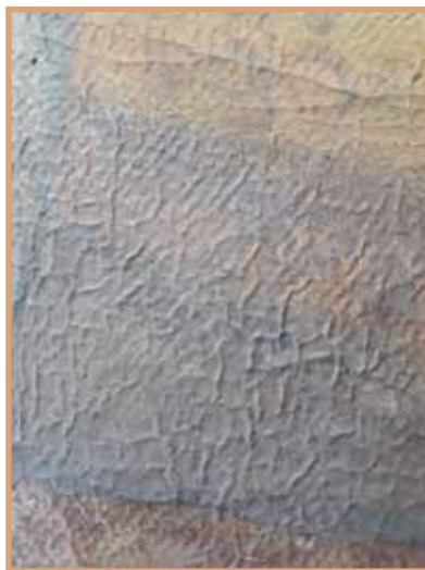
ชั้นสีเป็นรอยย่นหรือเป็นคลื่น เนื่องจากใช้น้ำมันมากเกินไป
