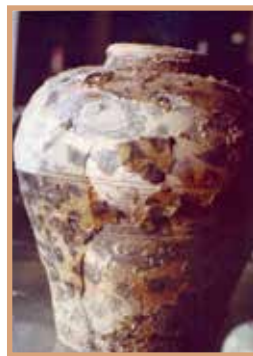
น้ำยาเคลือบบนเครื่องลายครามแตกป็นเป็นผงเนื่องจากแรงดันของผลึกเกลือ
