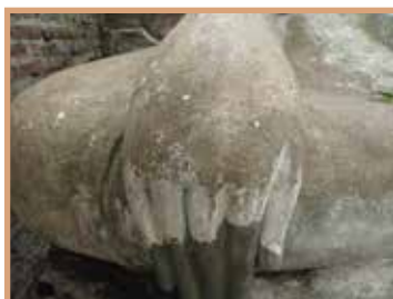
ร่องรอยการสึกกร่อนบน ผิวปูนปั้น หลังจากขจัด สารร้ายและบอออกไซด์
