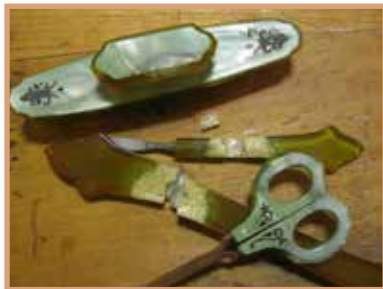
การเสื่อมสภาพของ กระดองเต่าเทียมที่ทำ จากเซลลูโลสไสเตรต
