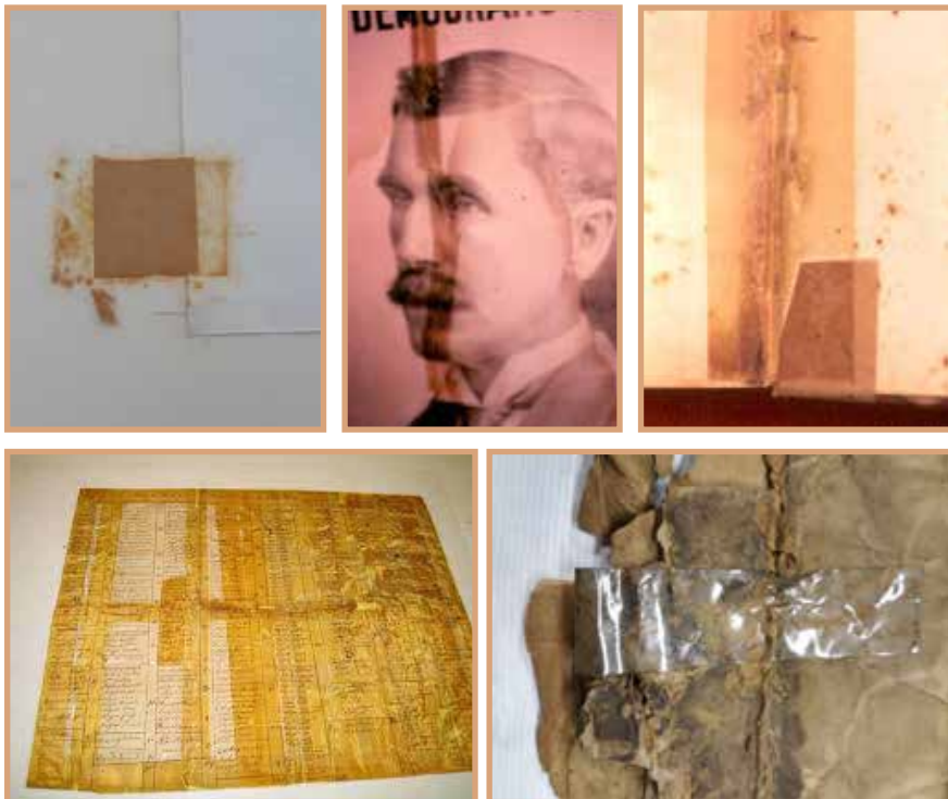
การยึดตรึงด้วยเทปกาว ทำให้เกิดคราบเปื้อนที่เอาออกยาก
