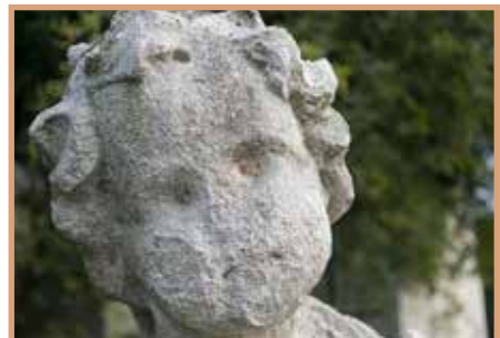
การสึกกร่อนผุพังของ หินปูนและหินอ่อนจาก การกระทำของฝนกรด
