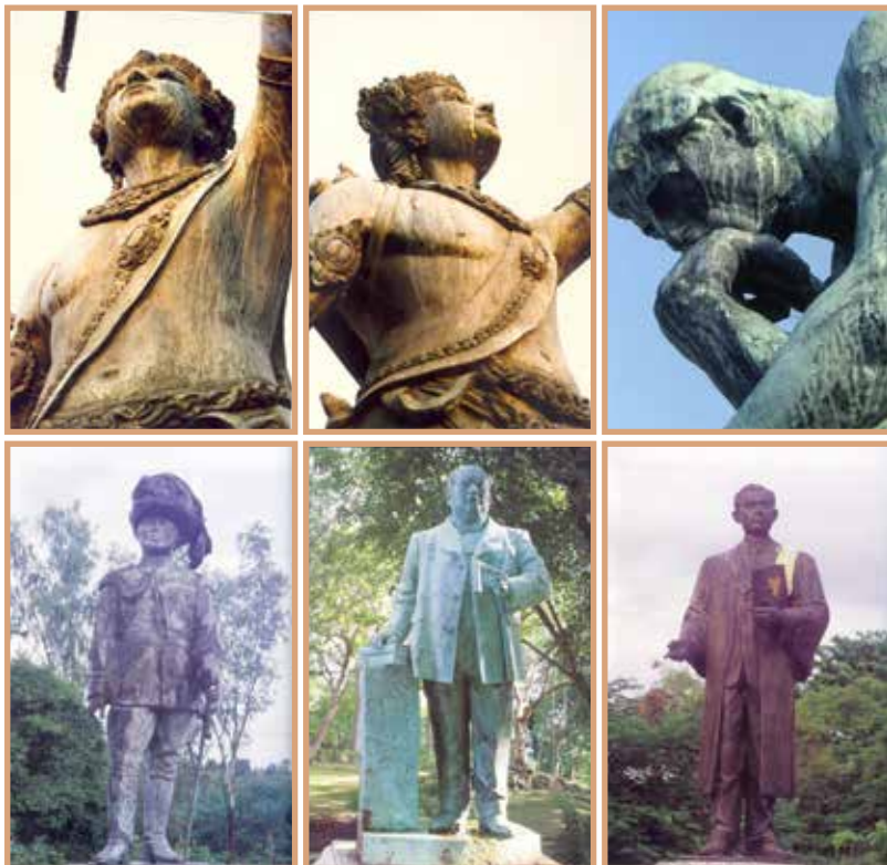
คราบสนิมสีต่าง ๆ เกิดจากโลหะทำปฏิกิริยากับก๊าซมลพิษในอากาศ
