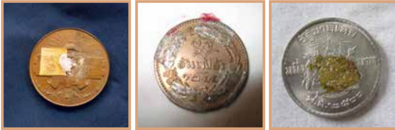
รอยต่างบนโลหะเกิดจากเทปกาวที่ใช้ยึดวัตถุให้อยู่กับที่
