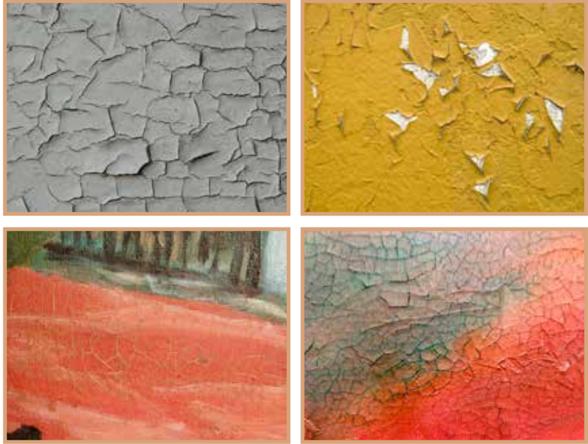
ชั้นสีมีความสามารถในการยึดและหดไม่เท่ากับชั้นรองรับ
