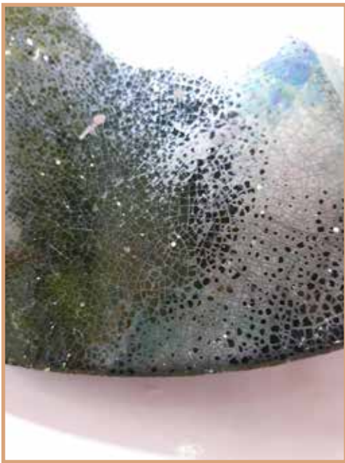
รอยแตกร้าวขนาดเล็ก บนกระเบื้องเคลือบที่อยู่กลางแจ้ง
